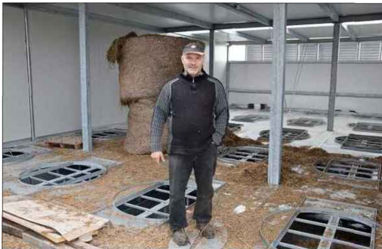
Jean-Pierre Monthubert dans son séchoir à foin qui peut sécher 24 bottes de 160 centimètres de diamètre en 2 fois 8 heures. (Ph. A.M.)
