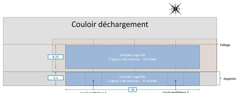
Proposition d'une installation d'une Centrale Cogen'Air
